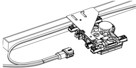
**WARNUNG:** Bringen Sie auf alle nicht verwendeten AC-Steckverbinder Verschlusskappen an, da an diesen Verbindern sonst Strom anliegt, sobald das System mit Strom versorgt wird. Verschlusskappen sind zum Schutz vor eindringender Feuchtigkeit erforderlich.
