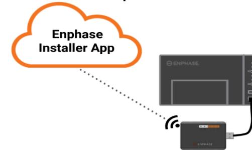
Enphase Mobile Connect ist ein Modempaket, das an Enphase IQ Envoy-S oder IQ Gateway angeschlossen wird und eine sonstige Internetverbindung vor Ort zur Überwachung eines Enphase Mikro-Wechselrichtersystems überflüssig macht. Durch das Hinzufügen des Enphase Mobile Connect zu einem Enphase PV-Anlage wird eine flexiblere Installation ermöglicht sowie eine zuverlässige Systemüberwachung unabhängig vom Internetdienst vor Ort geboten.
