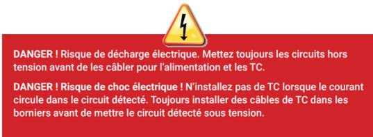
**REMARQUE :** Lors de l'installation de TC, il est important de faire correspondre les phases du TC et de la tension de détection. Identifiez les deux lignes c.a. à trois points : l'alimentation principale du centre de charge, l'Envoy et le disjoncteur de production solaire. Les couleurs des fils (généralement noir et rouge) peuvent ne pas toujours indiquer L1 et L2. En cas de doute, utiliser un multimètre pour vérifier.
