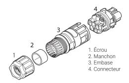
AVERTISSEMENT: Risque de défaillance de l'équipement. Ne mélangez pas les pièces des connecteurs mâle et femelle lors du montage des connecteurs.
