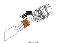
**B)** Raccordez les conducteurs au connecteur. Affectez les conducteurs conformément aux informations figurant sur le connecteur.
