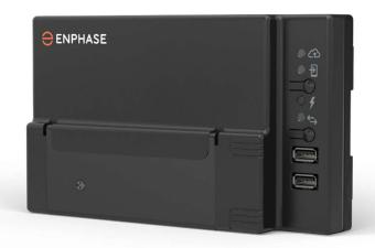
L'Envoy-S Metered è il gateway di gestione e comunicazione dei sistemi Enphase: consente la programmazione per la messa in funzione tramite app Enphase Installer Toolkit (ITK) e può gestire fino a 600 microinverter. Riceve e trasmette dati da e verso i microinverter in Powerline su onde convogliate, sfruttando le linee esistenti di alimentazione dei microinverter. Comunica via Internet con il cloud Enlighten grazie alla connessione LAN o WLAN con il router dell'utente.
