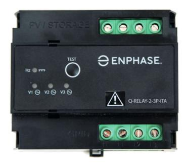
Il Q Relay 2.0 disconnette meccanicamente dalla rete i microinverter in presenza di anomalie sulla rete. Assolve il compito di protezione di interfaccia con la rete in conformità alla norma CEI 0-21 e rileva la componente continua immessa dai generatori. Consente l'esecuzione della funzione di autotest in impianti di potenza fino a 11,08 kW.
