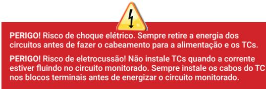
**OBSERVAÇÃO:** Ao instalar os TCs, é importante fazer a correspondência entre as fases de tensão do TC e do sensor. Assegure-se de identificar consistentemente as duas fases de CA em três pontos: na alimentação do quadro de distribuição principal, no IQ Gateway e no disjuntor de produção de energia solar. As cores dos fios (normalmente preto e vermelho) nem sempre identificam L1 e L2 de forma consistente. Em caso de dúvida, use um multímetro para verificar.
